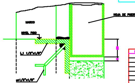
NOTA: LA PUERTA Y EL MARCO SE CONSTRUIRAN DE CARPINTERIA METALICA DE CHAPA DE Fe N°14 O DE PERFILES DE Fe. LAS BISAGRAS SERAN DEL TIPO FICHA DE Fe. LA CERRADURA LA PROPORCIONA EDESUR E INSTALAR EN EL MOMENTO DEL MONTAJE, RESPETANDO LOS VANOS, LAS DIMENSIONES DE VENTILACIONES Y LA ROBUSTEZ REQUERIDA. EL CLIENTE PODRA PRESENTAR OTRAS VARIANTES PARA SU APROBACION. PASADORES/VARELLA Fe #10mm Y CARO Fe NEGRO #12mm.
